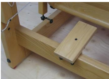
Voetsteun; deze kan naar keuze links of rechts op de voetregel geplaatst worden. Tijdens het weven kan de voet die niet voor het trappen wordt gebruikt hierop rusten.
